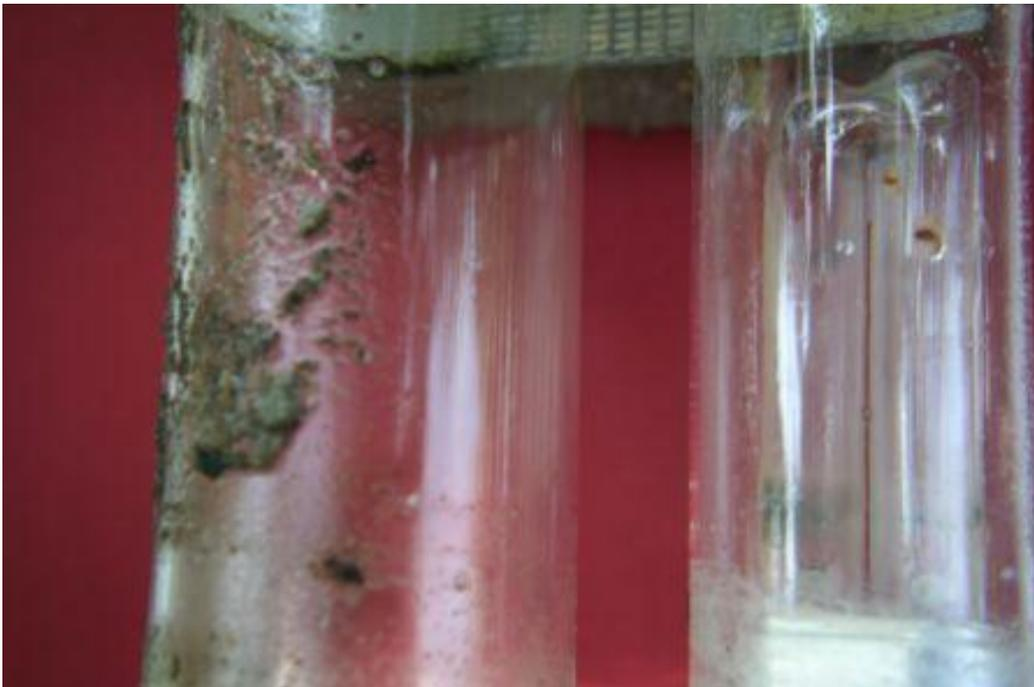
**Foto 14** Testsonde 3. Vorversuch nach 12 Monaten mit UVC-Beleuchtung
